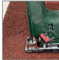
Auch mit der Stichsäge und einem Holzsägeblatt können die Matten geschnitten werden. Stellen Sie eine niedrige Sägeschwindigkeit ein.
